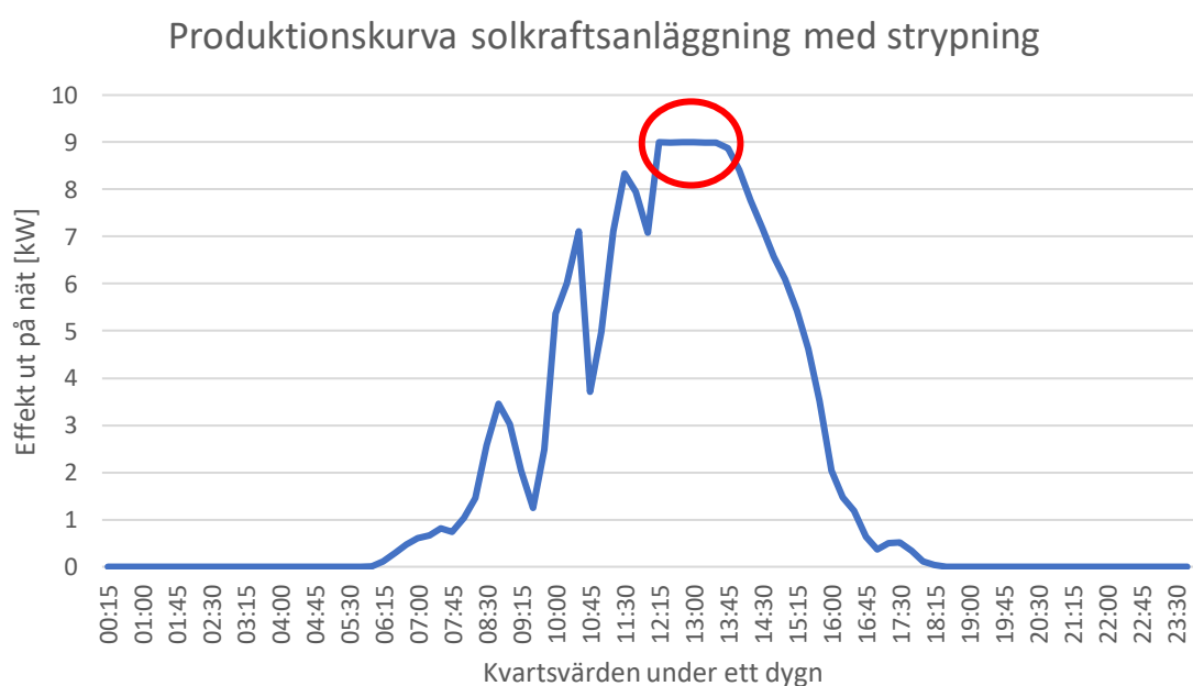
Figur 1 – Produktionskurva med en strypning av uteffekten vid 9000W.
